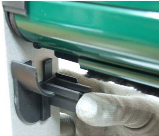
4 Fissaggio copritestata dx-sx a scatto
